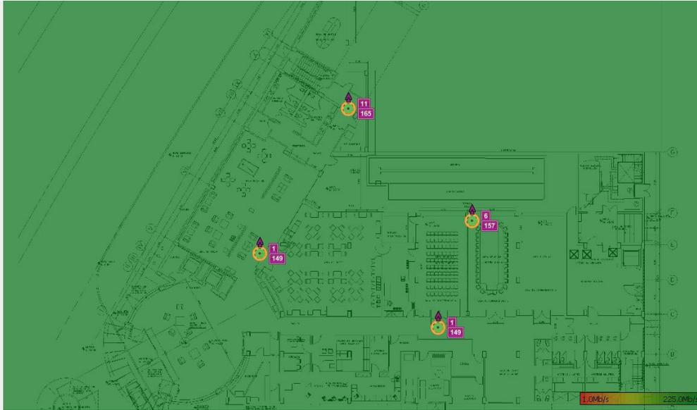
Figura 16. Tasas de transmisión en planta baja 210 / 225 Mbps.
