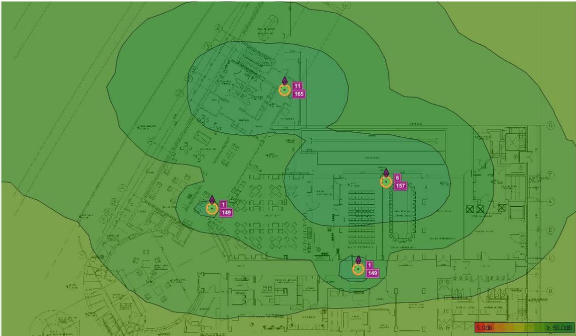
Figura 21. Relación señal a ruido (SNR) en planta baja.
