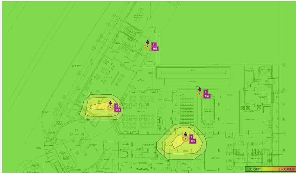
Figura 18. Niveles de interferencia en planta baja
