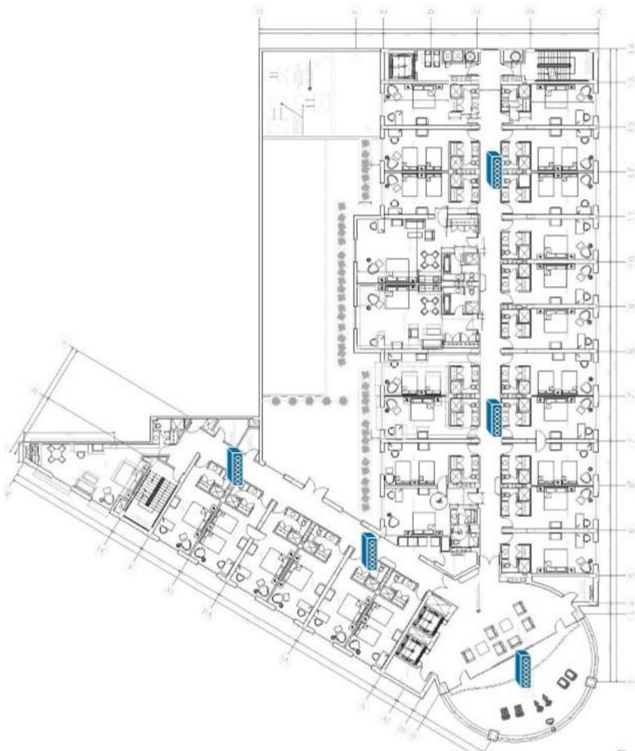
Figura 60. Plano de ubicación de puntos de acceso en primer piso.
