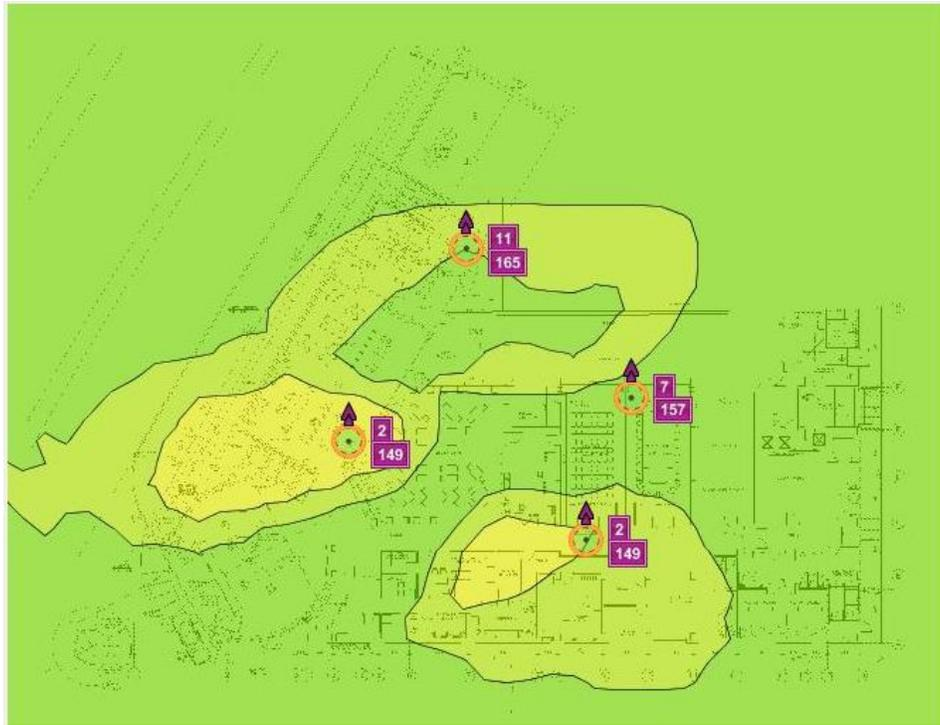
Figura 53. Traslape de frecuencias (Overlapping).
