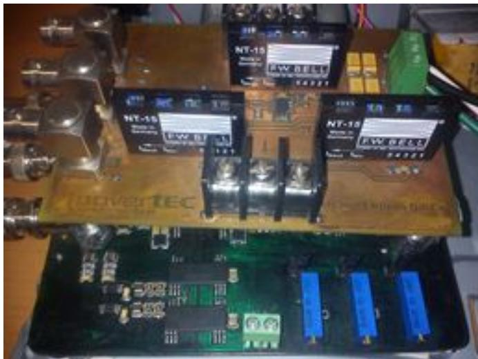
**Figura 3.10:** Tarjeta de medición de corrientes
