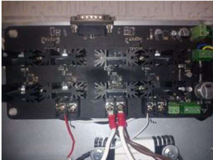
**Figura 3.8:** Implementación del convertidor *Back to Back*
