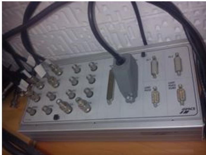
Figura 3.9: Panel de conexiones de la tarjeta dSPACE
