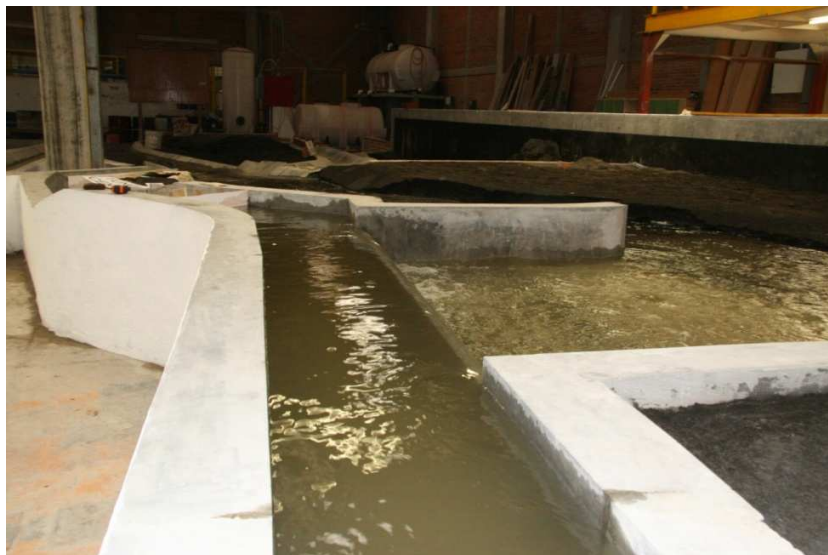
Vista lateral del vertedor TEO para gasto de 170 \text{ m}^3/\text{s}
