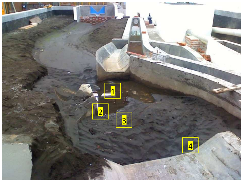
Fig. 9.3.2.2 Sitios de medición de socavación y configuración final después de una descarga de 170 \text{ m}^3/\text{s}
