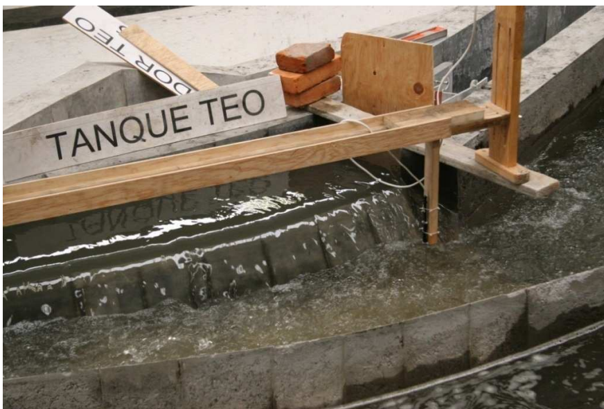
Medición al final del tanque del vertedor sobre la plantilla
