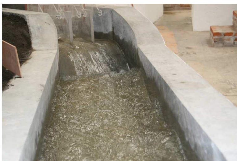
Fluctuaciones del flujo (en la curva) aguas abajo de las compuertas (compuertas abiertas, vista desde aguas abajo hacia aguas arriba)
