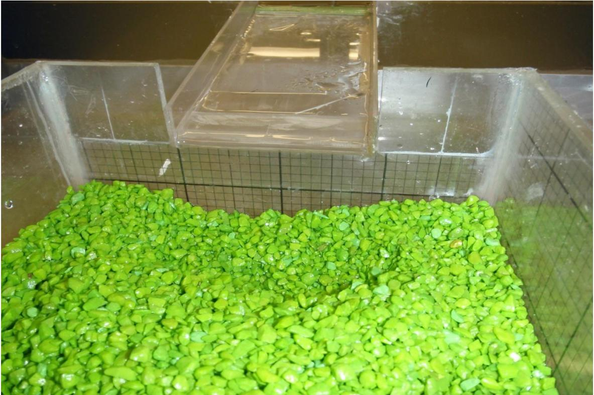
Figura 4.6 Socavación provocada por el gasto mínimo
