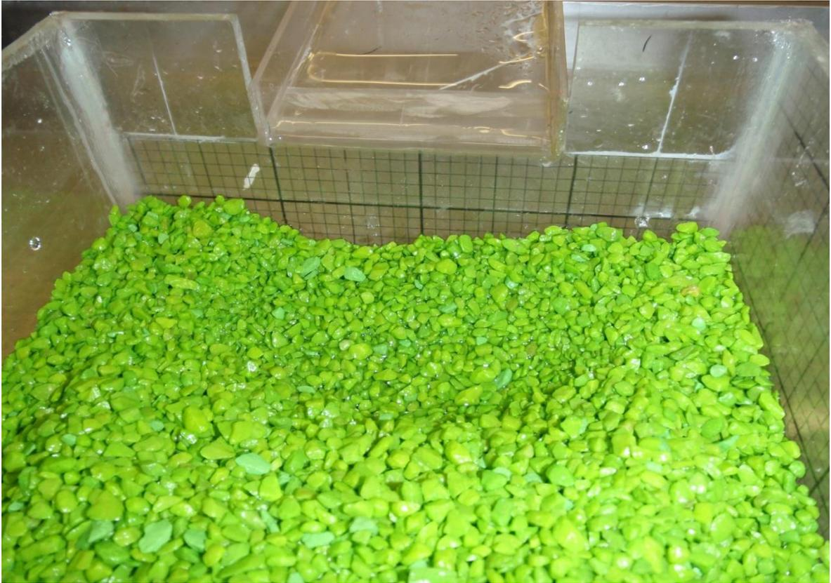
Figura 4.5 Socavación provocada por el gasto medio
