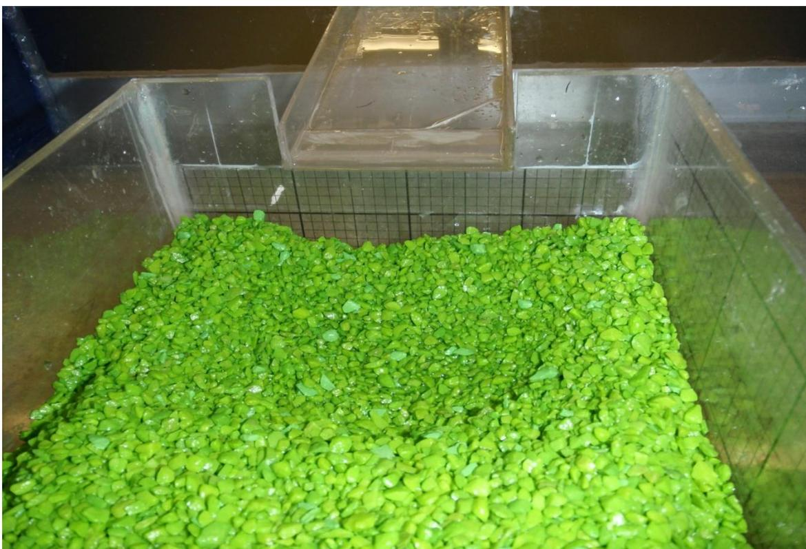
**Figura 4.4 Socavación provocada por el gasto máximo**
