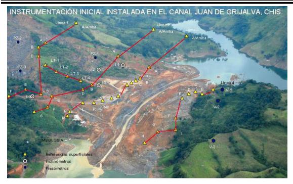
Fig. 15. Instrumentación inicial instalada en el canal.
