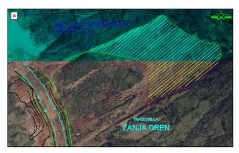
Fig. 23. Esquema de la captación de escurrimientos de la zanja-dren.
