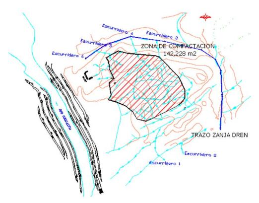
Fig. 24. Esquema de la captación de escurrimientos.
