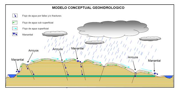
Fig. 34. Modelo conceptual geohidrológico.
