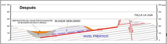
Fig. 4. Mecanismo de falla.
