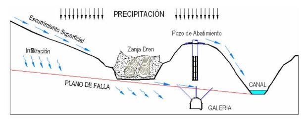
Fig. 21. Esquema de drenaje de la zona deslizada.
