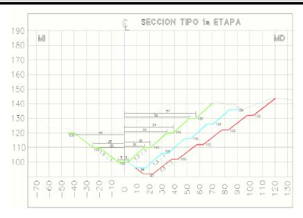
Fig. 16. Sección transversal del trazo del canal.
