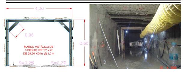
Fig. 26. Esquema y vista de la galería de drenaje aguas abajo.
