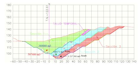
Fig. 11. Sección esquemática del canal que muestra los volúmenes a excavar en cada etapa.
