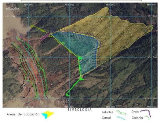
Fig. 20. Áreas de captación, galería-dren y dren-corona.
