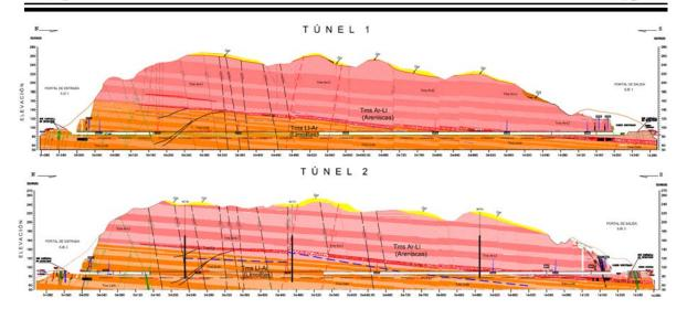
Fig. 33. Geología de los túneles de conducción, corte longitudinal por el eje de cada túnel.
