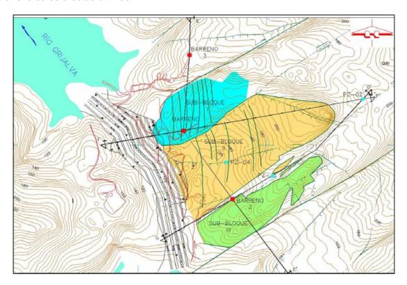
Fig. 6. Bloque deslizado.
