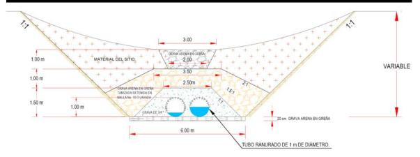
Fig. 22. Esquema de la zanja-dren.
