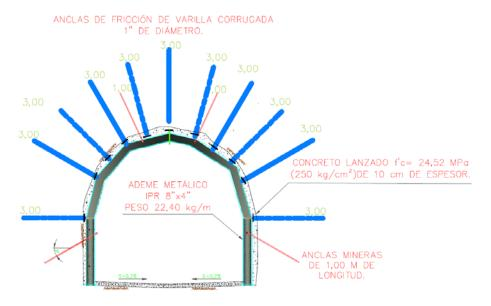
Fig. 29. Esquema de los tratamientos de refuerzo en las galerías.
