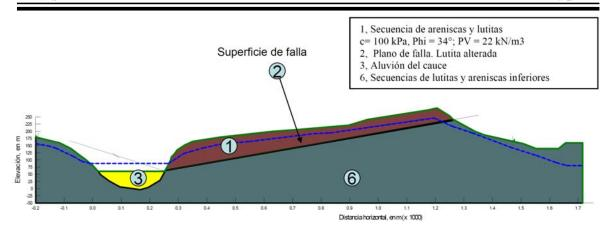
Fig. 8. Estratigrafía en la zona de falla.
