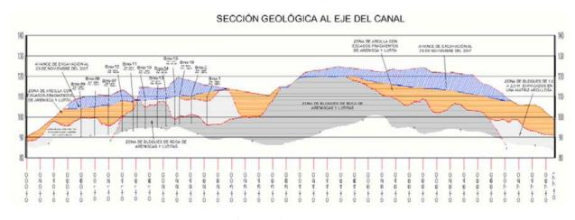
Fig. 14. Sección geológica al eje del canal.
