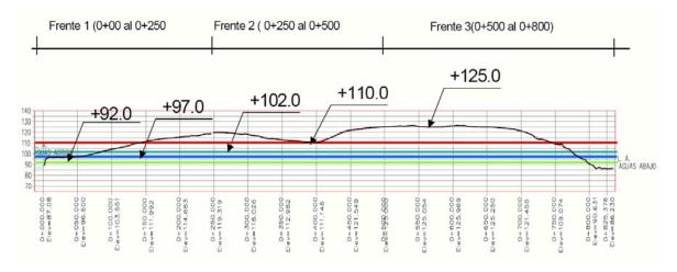
Fig. 13. Sección longitudinal del trazo del canal, volúmenes de excavación.
