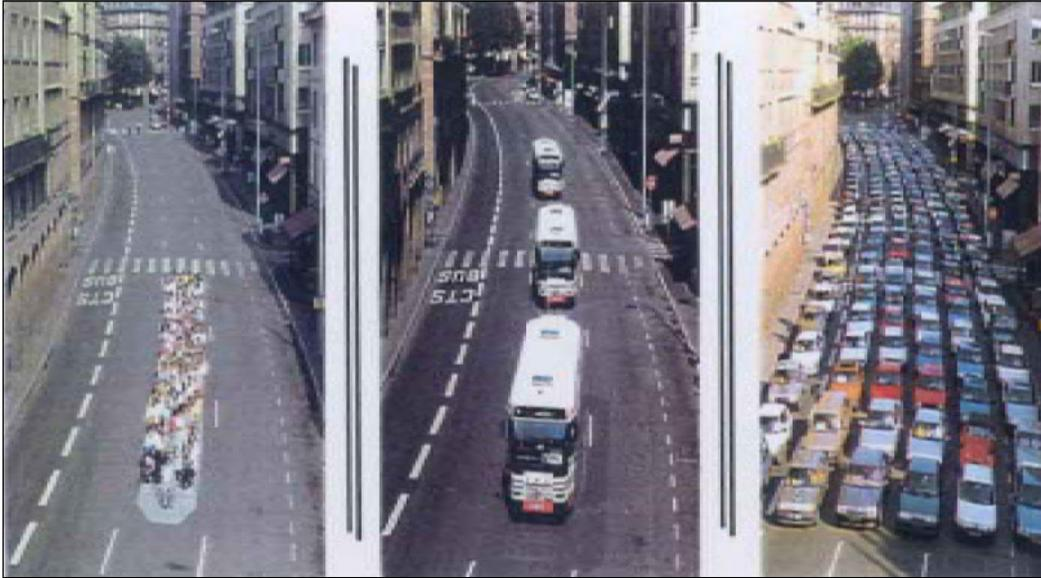
**Figura 2.3.5.1. Optimización del espacio por medio de sistemas BRT**
