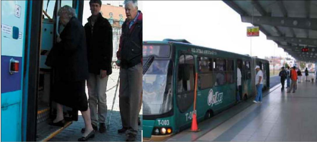
**Figura 2.3.5.5. Vista de la diferencia entre un asenso a nivel y uno no a nivel**
