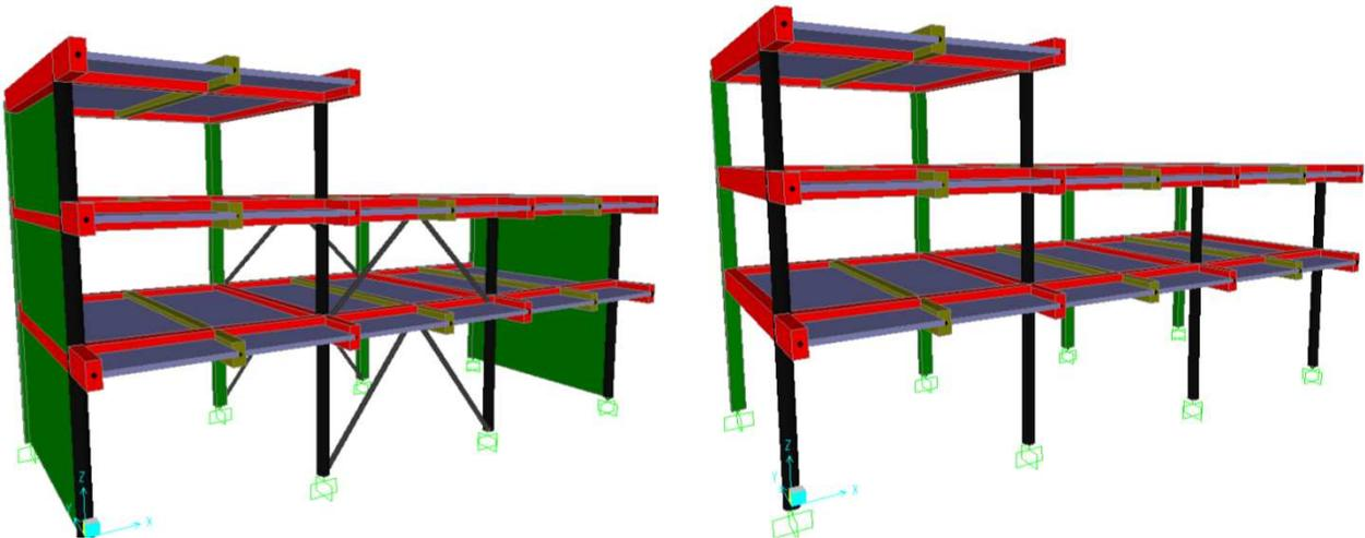
Fig. 30.- Ejemplos de dos tipos de estructuras y su modelación en el Programa Etabs, se observar la rigidez de cada una de ellas y sus grados de libertad.
