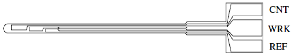
Figura 6.4: Diagrama de los electrodos del sensor de glucosa Medtronic
