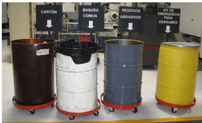
Figura 4.4 - Isla de contenedores para RME, con señalamientos.
