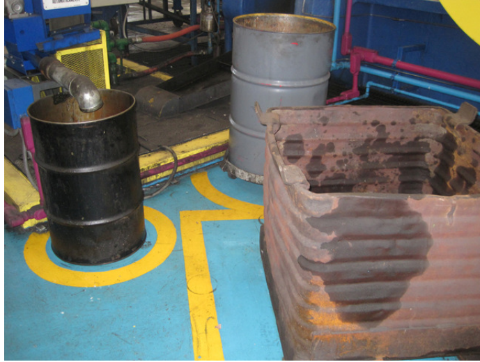
Figura 4.3 - Contenedores dentro de sus áreas señalizadas.
