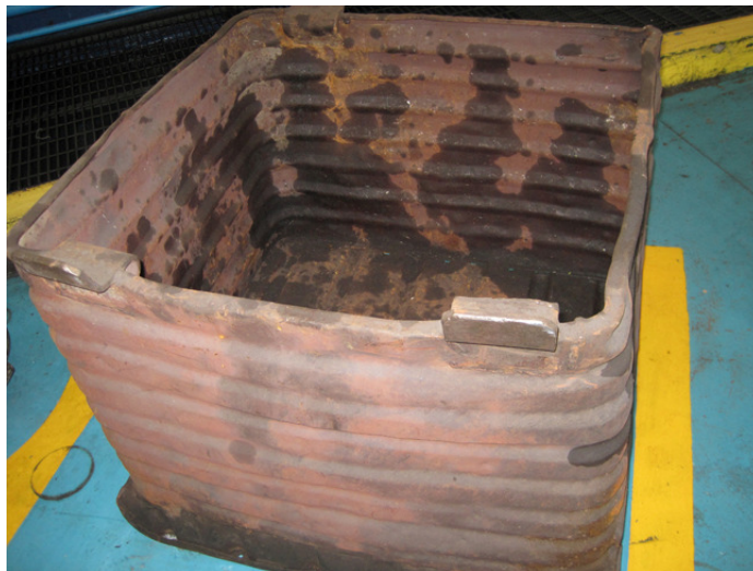
Figura F.1 - Contenedor para residuos metálicos generados en forja.
