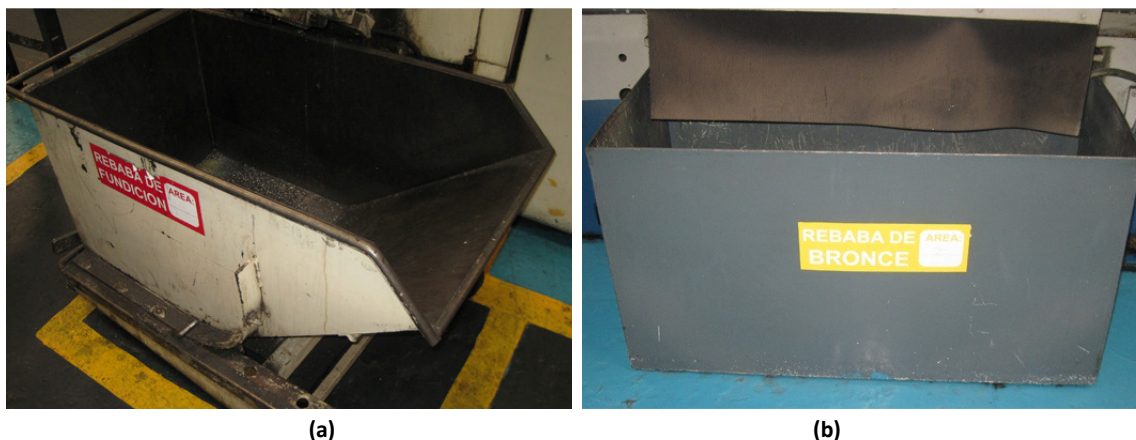
Figura F.2 - Contenedores para rebaba empleados en Planta 1.
