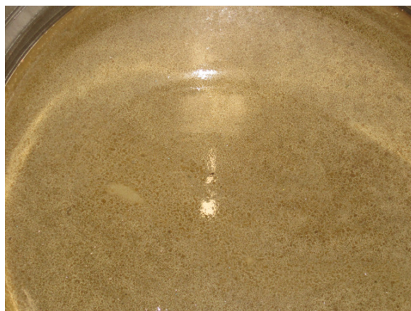
Figura E.1 – Agua contaminada con aceite.
