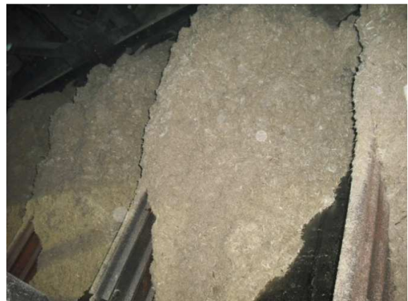
Fotografía A5.6 Bagazo enviado a calderas
