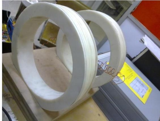
**Figura 4.7** Bobinas de Helmholtz maquinada y con carretes embobinados.
