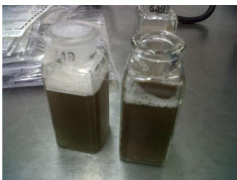
Figura 4.22. Prueba nitrato muestra sin diluir
