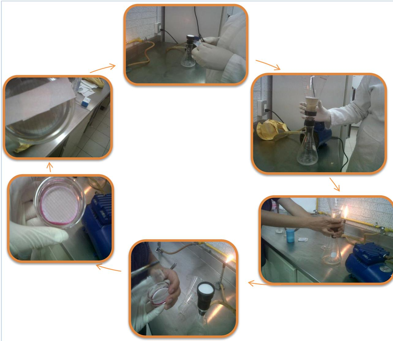
Figura 4.34. Procedimiento prueba coliformes fecales y totales
