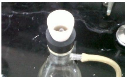
Figura 4.4. Prueba sólidos filtrables
