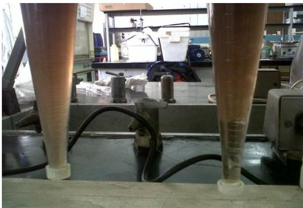
La prueba se realizó llenando los 3 conos Imhoff con la muestra hasta la marca de 1 [L]. Se colocaron en la gradilla para mantenerlos en posición horizontal. Transcurridos los 45 [min] (necesarios para la sedimentación de los sólidos) se observó que no hubo
