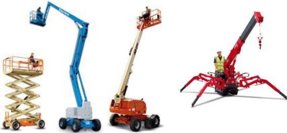
Ilustración 3.12 Equipos especiales que se podrían utilizar como minigrúa y mewps
