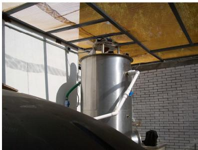
Vista parcial del reactor anaerobio R-I
