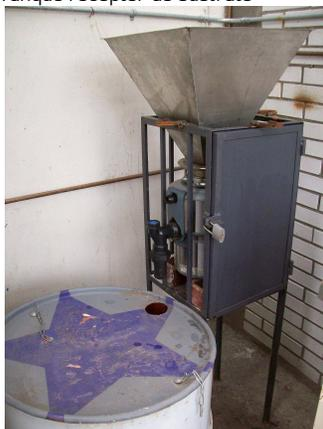
Triturador y tanque receptor de sustrato
