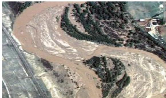
Figura 5.10. Socavación por migración lateral. Gary L. Lewis (2004).
