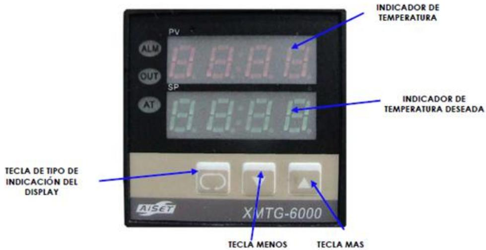
Figura 15. Pirómetro
