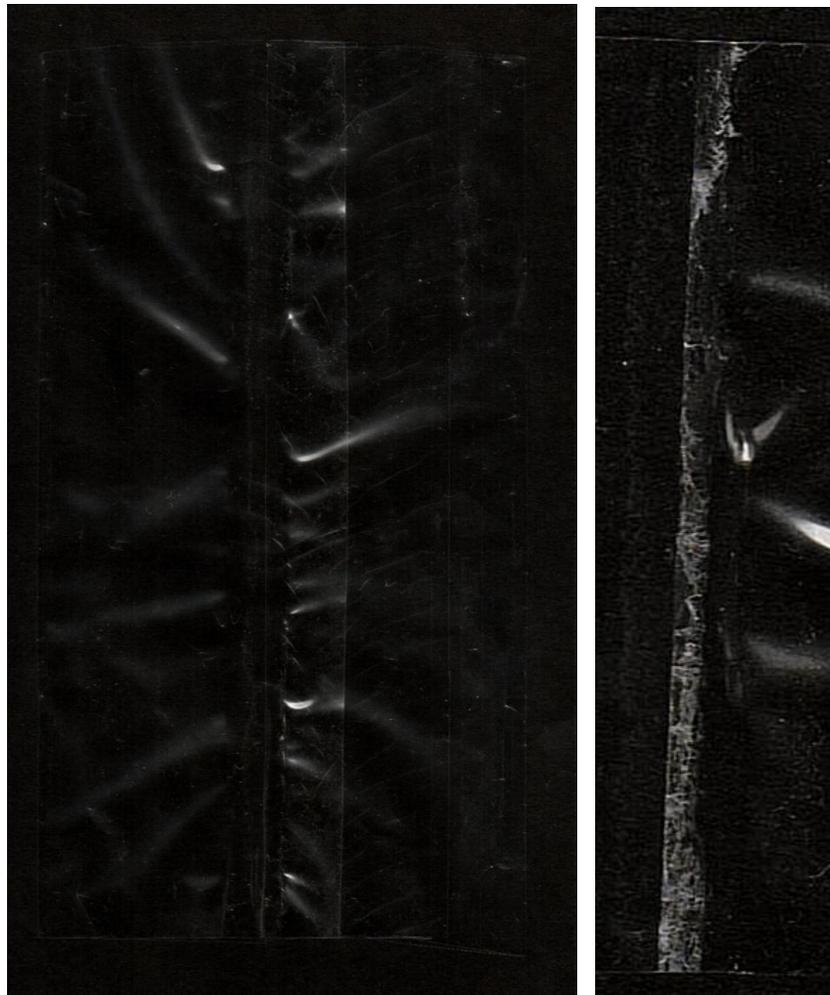
Figura 41. Segmento de tubo de película plástica T=135°C
