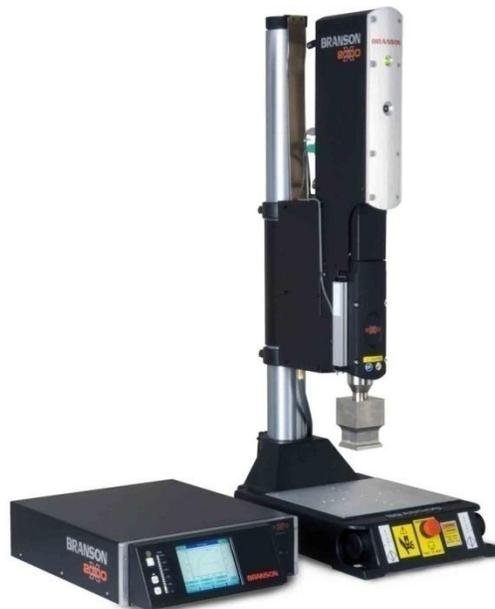
Figura 70. Equipo de sellado con ultrasonido
