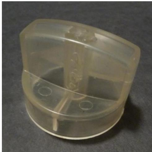
**Figura 58. Pieza inyectada en PLA**
