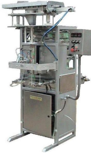
**Figura 17. Máquina envasadora vertical**
