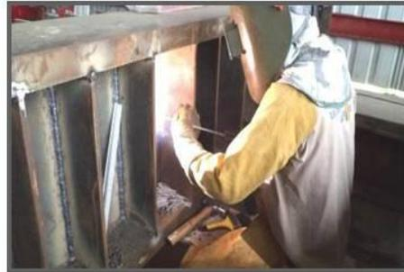
Aplicación de soldadura a cartabones en vigas del marco de anastre.
