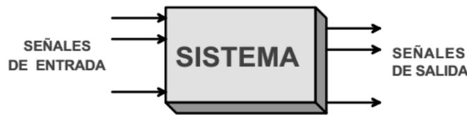
**Figura 4.1.:** Diagrama de bloques de un sistema
