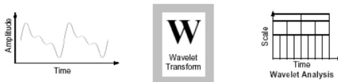
Figura 4.5.: Esquema de la TW
