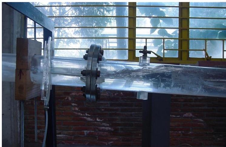
**Figura 4.3. Válvula colocada en la sección de medición del dispositivo**
