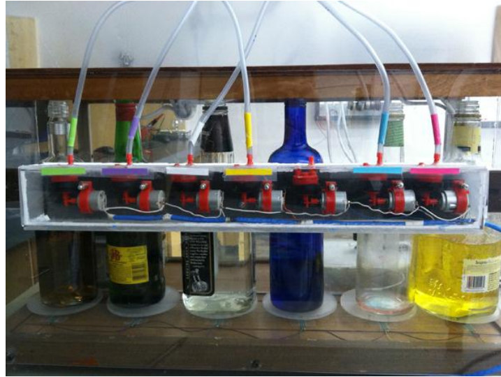
Figura 2.b.3. Mangueras y arreglo de bombas.
