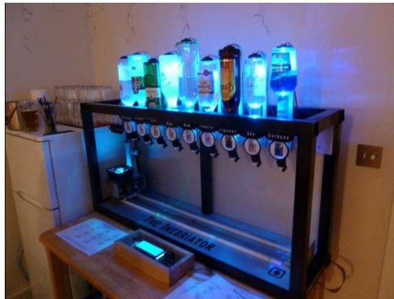
Figura 2.b.8. Leds en botellas mismas que están arriba para aprovechar la fuerza de gravedad y usar válvulas para control del fluido.
