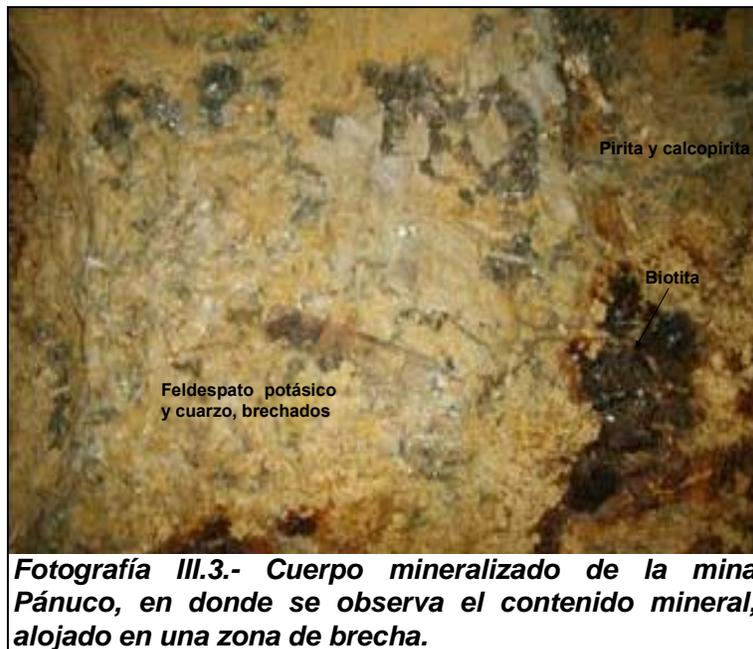
**Fotografía III.3.- Cuerpo mineralizado de la mina Pánuco, en donde se observa el contenido mineral, alojado en una zona de brecha.**
