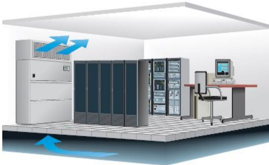
*Figura 20 Aplicación con succión en piso falso, descarga sin ductos (Technologies, Emerson, 2005)<sup>17</sup>.*
