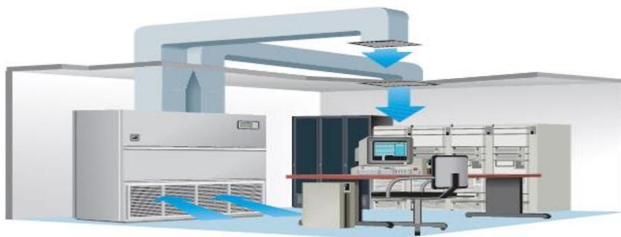
Figura 18 Aplicación con ductos de descarga direccionados. (Technologies, Emerson, 2005)<sup>17</sup>.
