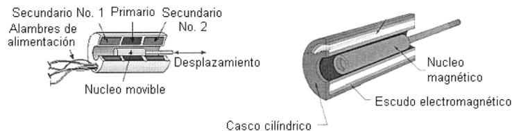
Figura 2.6 Sección de los LVDTs.
