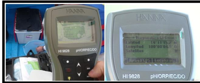
**Figura 3. 4 Medidor multiparámetrico con GPS HI 9828**
