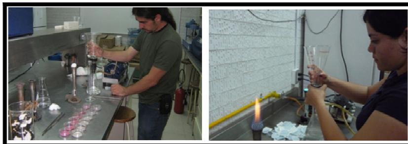
**Figura 3.5 Método de filtración de membrana para la determinación de los coliformes totales y fecales.**
