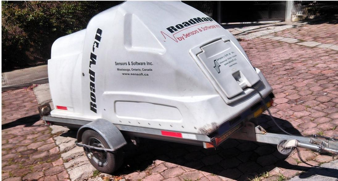
**Figura 4. Radar de Penetración Terrestre. GPR.**
