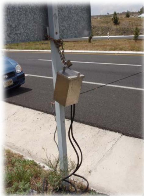
**Figura 18. Mangueras debidamente conectadas en la Caja Metálica**
