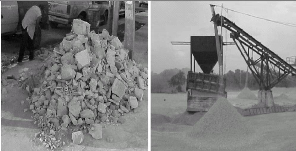
Fig. II.2.1 Acopio de materia prima (der.) y obtención de agregados (izq.).
