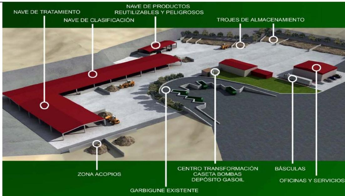
Fig III.3.2.- Características de una planta fija de tratamiento de RCD's.
