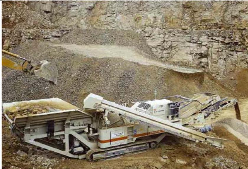
Fig. II.3.2.1.- Planta trituradora móvil ( Lokotrack LT1213S).
