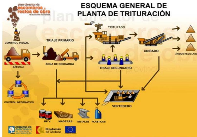
fig. II.2.3.- Esquema general de planta de trituración.
