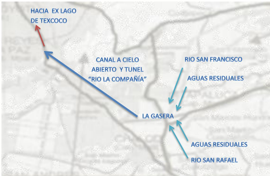
Ilustración 12: Sistema actual de manejo de aguas residuales
