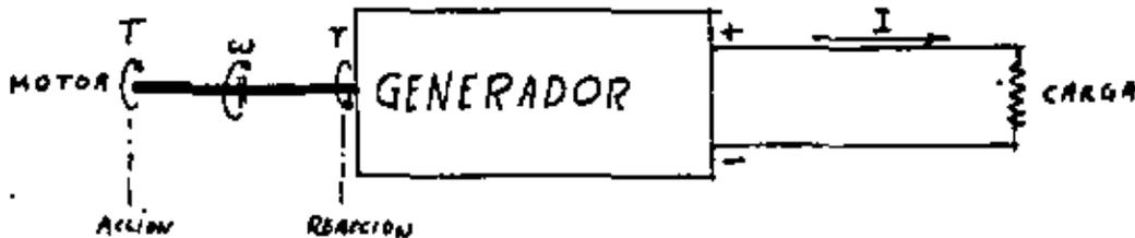
Fig. 1 La máquina de C.D. operando como generador
