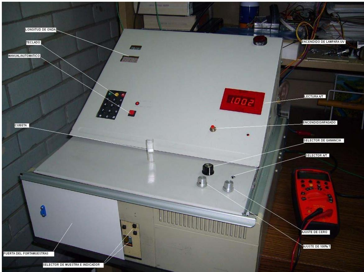
**Figura 8.4. Fotografía del espectrofotómetro diseñado.**
