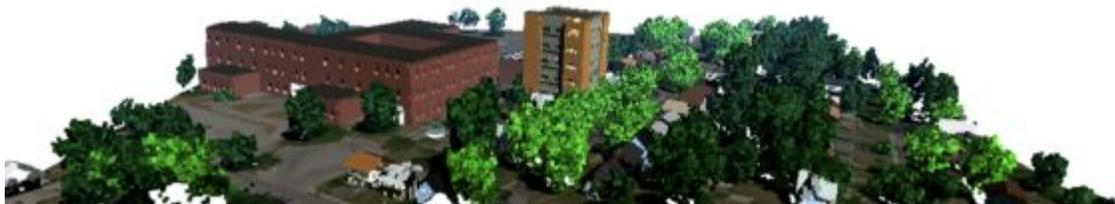
(c) Modelo tridimensional obtenido a partir de sus valores X, Y, Z.
