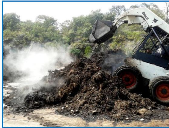
**Ilustración 17. Control de temperatura mediante volteo de pilas. Planta de Compostaje UNAM**
