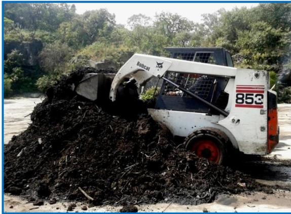
**Ilustración 16. Volteo de pilas de material vegetal compostado. Planta de Compostaje UNAM**
