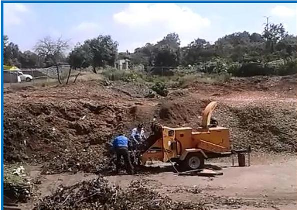
**Ilustración 10. Proceso de triturado de material vegetal en Planta de Compostaje UNAM**
