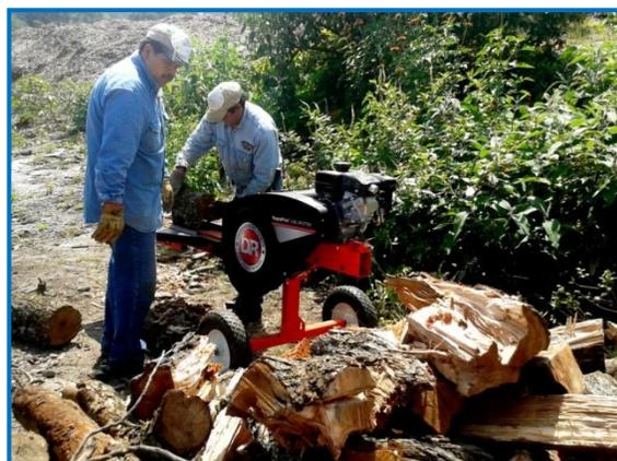
**Ilustración 13. Trituración de troncos pequeños en leñadora. Planta de Compostaje UNAM**
