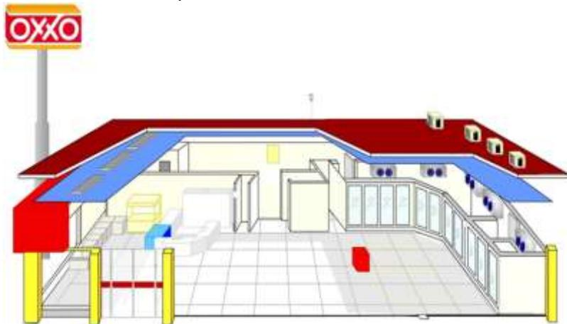
Figura 6b. Ubicación de equipos de refrigeración en una tienda típica OXXO
