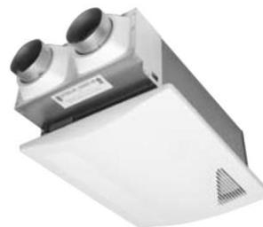
Posee dos modos de funcionamiento ajustables durante la instalación: uno que provee 40 CFM en operación a plena carga y 20 en baja velocidad, y otro que provee 20 CFM a plena carga y 10 en baja velocidad.
