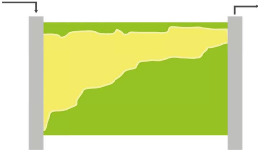
Fig. I.13. El fenómeno de boyancia del gas entre pozos.
