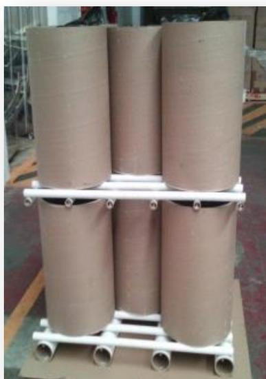
Figura 6. Tarima elaborada de tubos de cartón de diferentes medidas y espesores (Fotografía propiedad de la Empresa de estudio, 2012)
