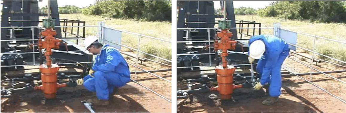
**Fig.4.9 Conexión de la pistola de gas.**
