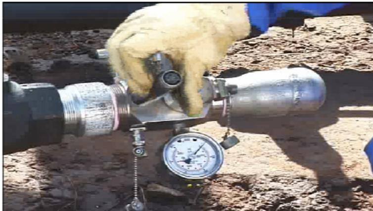
**Fig. 4.10 Conexión del transductor de presión.**
