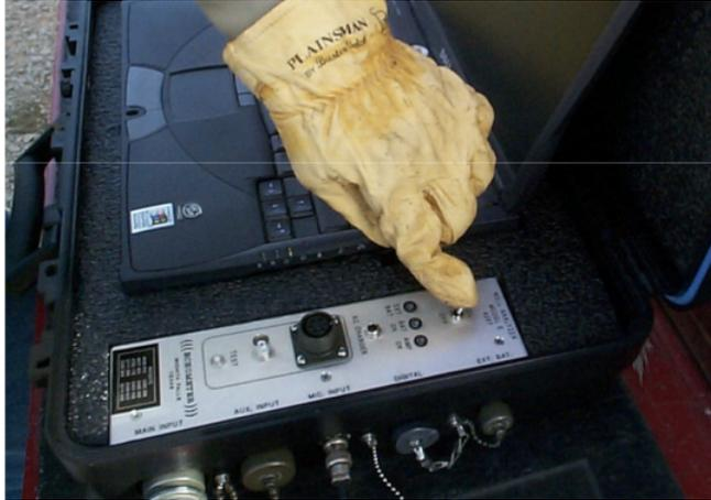
a) Encendido del equipo ECHOMETER
