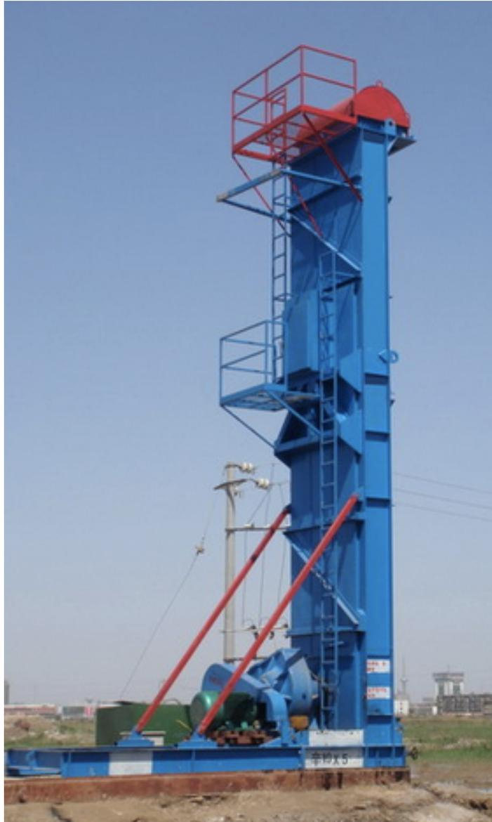
*Fig. 2.8 Unidad de Bombeo Mecánico Rotaflex.*
