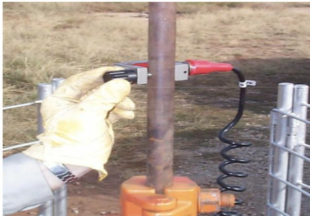
Fig. 5.12 Conexión del cable al PRT.
