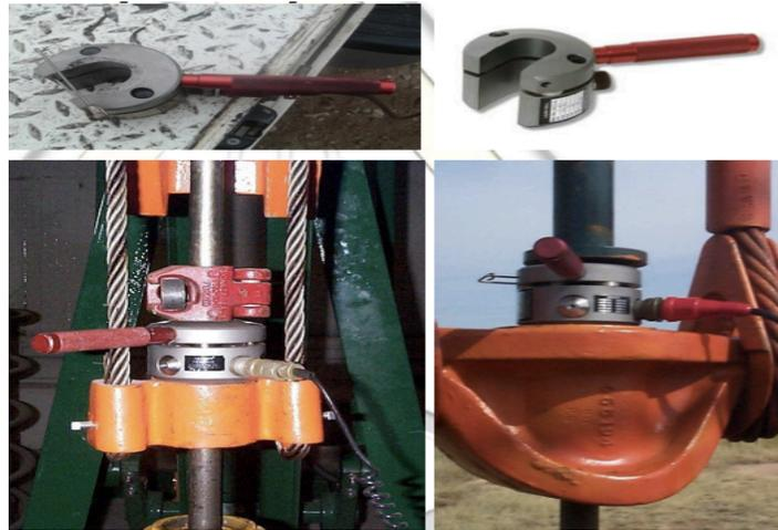
**Fig. 5.3 Transductor tipo herradura.**
