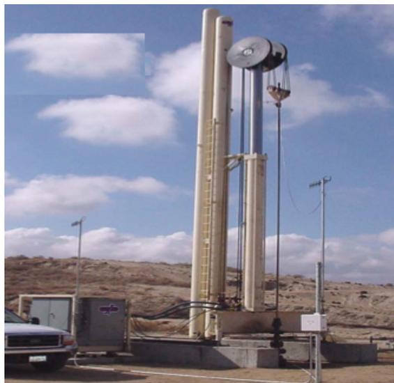
**Fig. 2.4 Unidad de bombeo mecánico Dynapump.**
