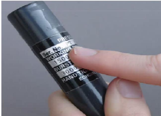
**Fig. 4.15** Número de serie del transductor de presión.
