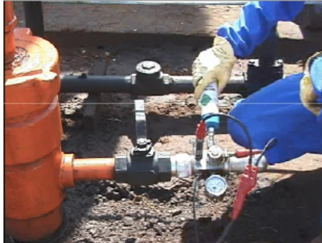
Fig. 4.17 Llenado de la cámara de gas.
