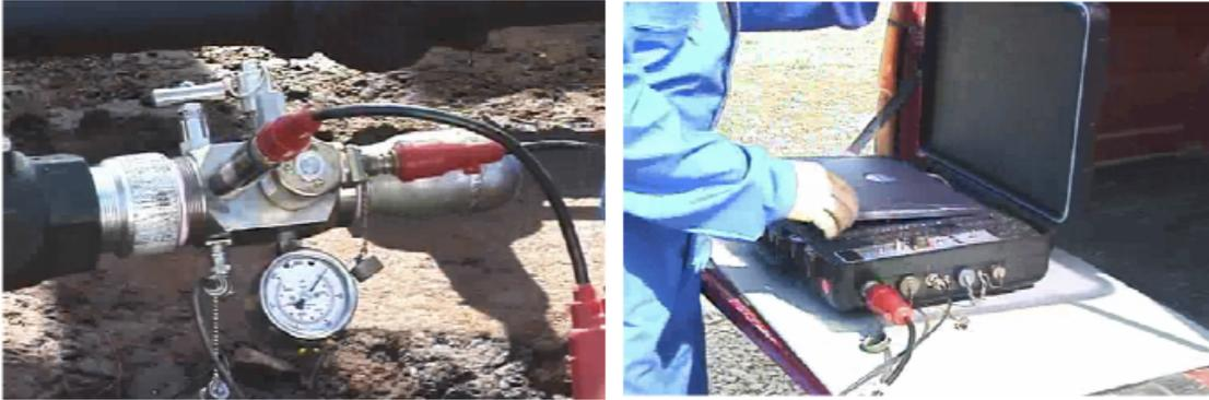
**Fig. 4.11 Conexión de cables a la pistola y al equipo de cómputo.**
