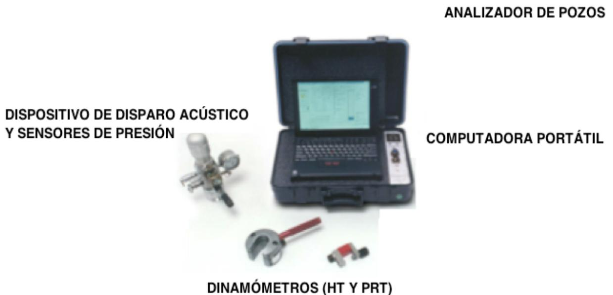
Fig. 4.1 Equipo de medición ECHOMETER.
