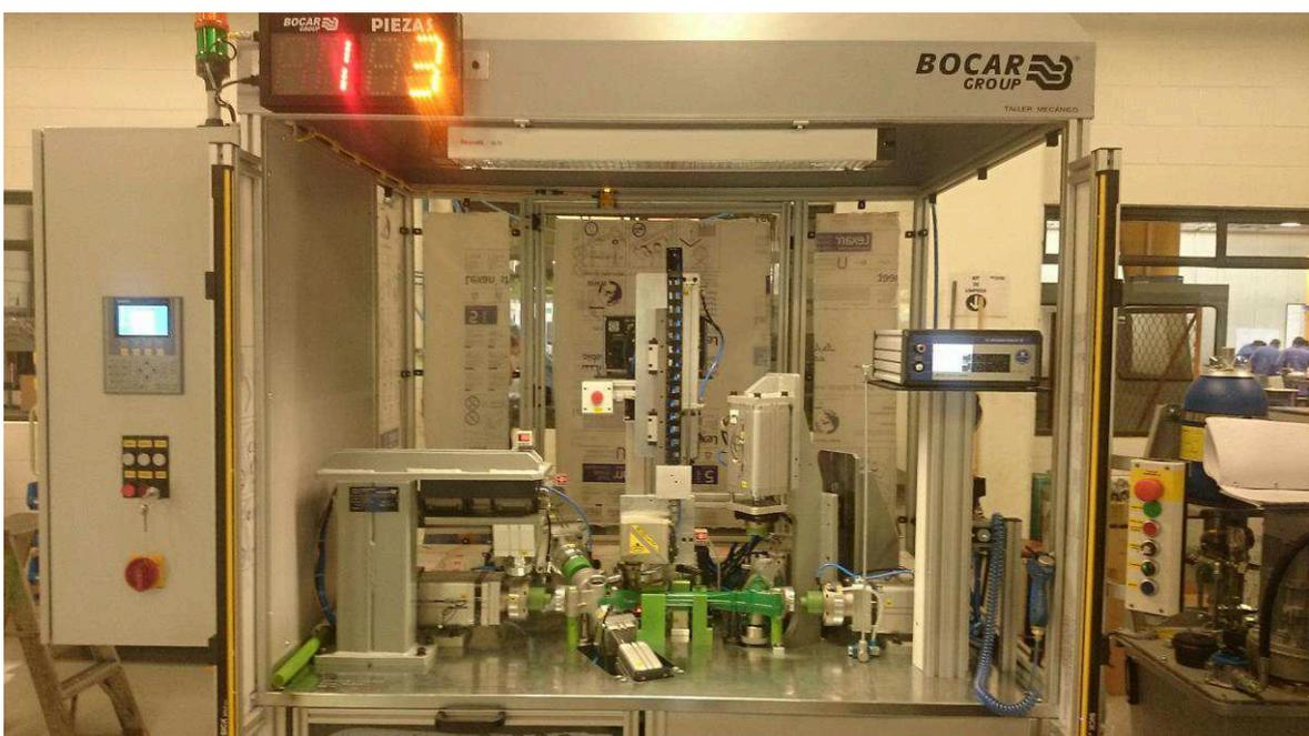
**Imagen 26. Máquina para prueba de hermeticidad a autoparte "rack and piñon"**
