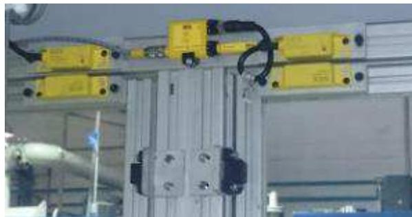
Imagen 34. Sistema de seguridad en puertas
