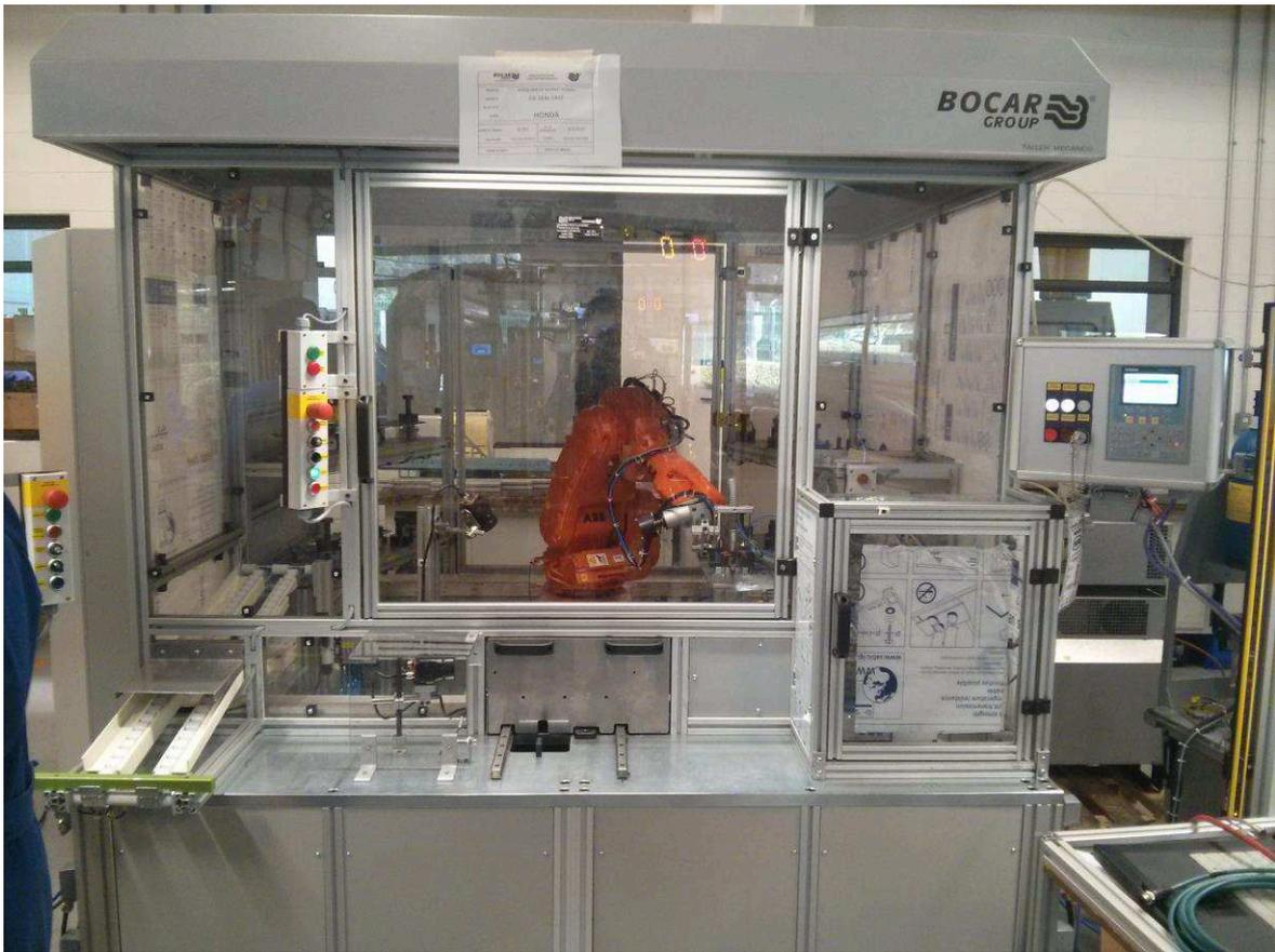
**Imagen 25. Máquina para aplicación de adhesivo y curado.**
