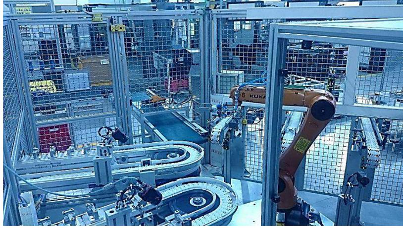
**Imagen 23. Máquina para ensamble de bujes (Bandas de entrada y salida)**
