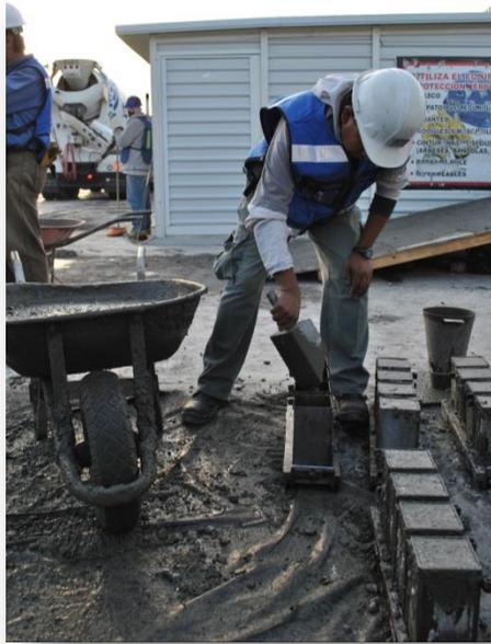
Se realizará un remezclado de la muestra tomada con una pala donde se deberá prevenir la segregación y el concreto se distribuirá homogéneamente en el molde.
