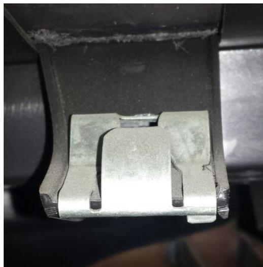
**Figura 4.17 Posición de Grapa metálica**
