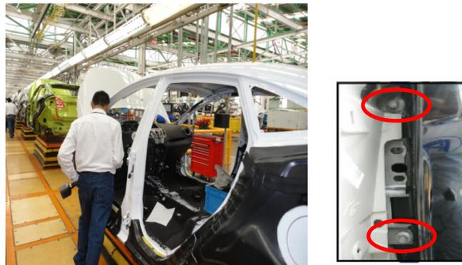
**Figura 4.13 Operación de apriete de tornillos en la instalación del panel de instrumentos**
