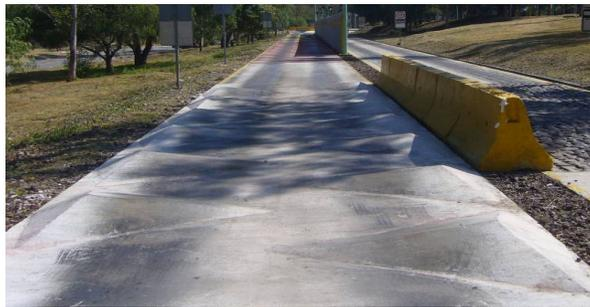
Figura 4.1 Zona de twist en la pista de prueba
