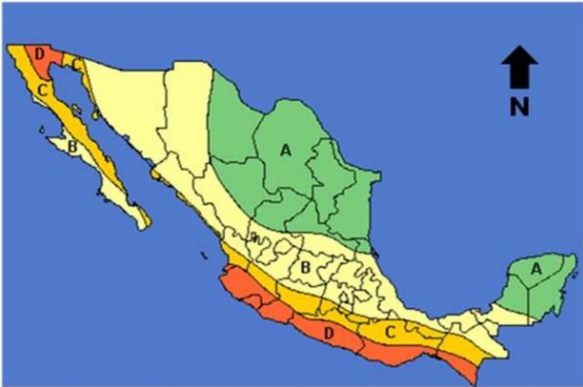
**Figura 1.2** Zonificación sísmica de México, según el Manual de Obras Civiles de la Comisión Federal de Electricidad
