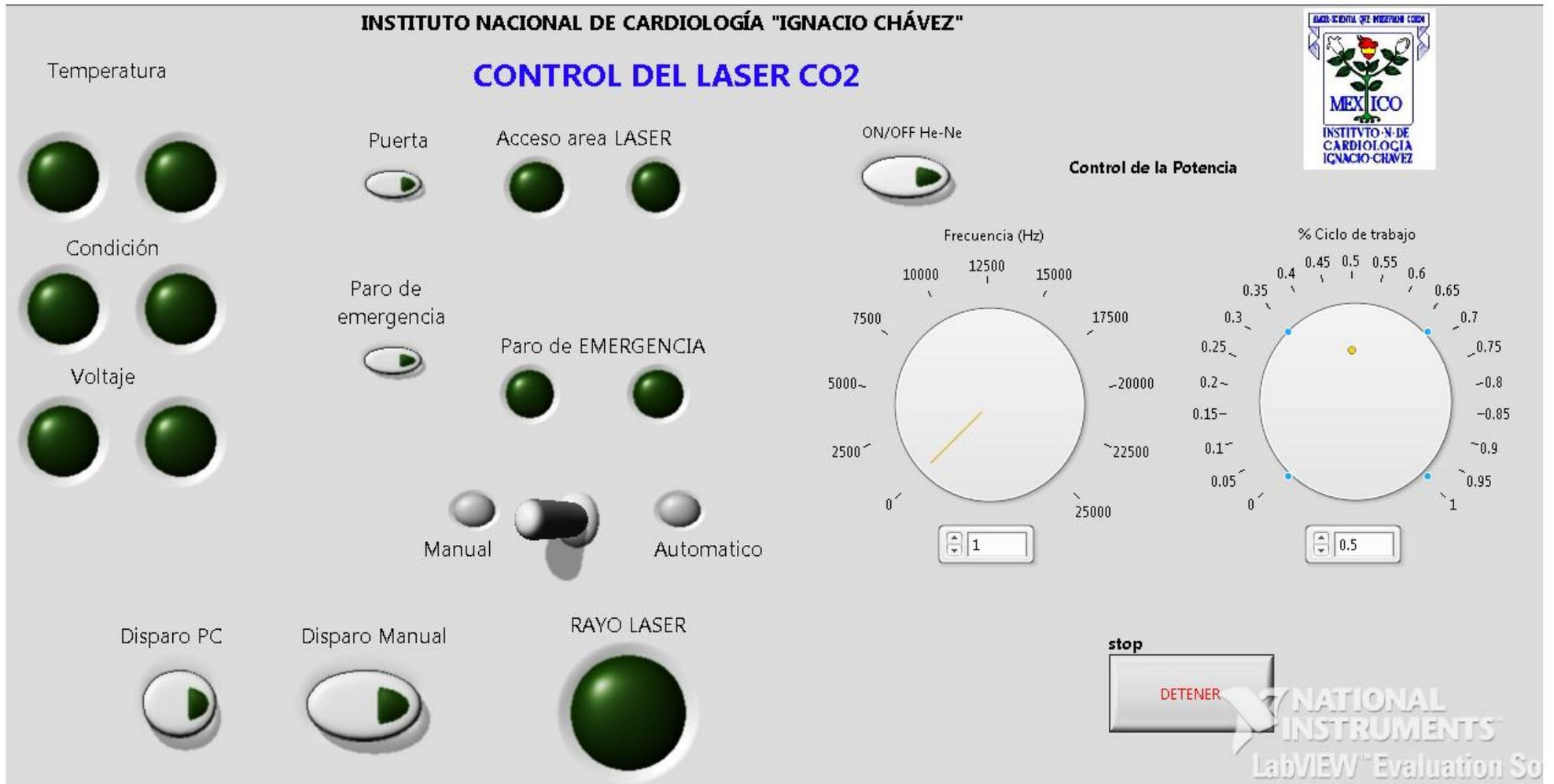
**Figura 27.- Interfaz realizada para el monitoreo y control del rayo láser sistema CO<sub>2</sub>**
