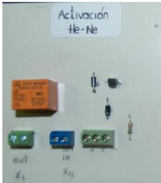
Figura 26.- PCB para Activación del láser He-Ne sistema de alineación para el rayo láser CO<sub>2</sub>
