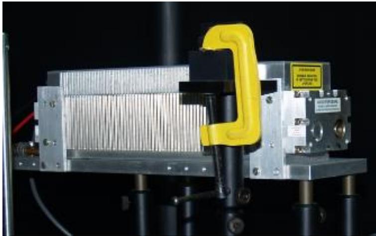
Figura 17.- Resonador Láser CO<sub>2</sub> GM-30 en el INCICH
