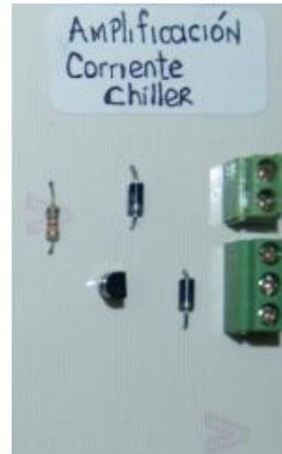
Figura 25.- PCB para etapa de Potencia sistema de enfriamiento del cabezal láser CO<sub>2</sub>
