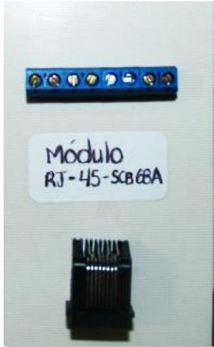
Figura 24.- PCB comunicación RJ-45 del cabezal láser CO<sub>2</sub>
