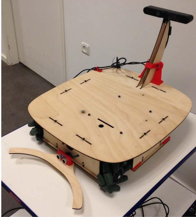
Figura 28. Foto del Robot Móvil Omnidireccional ensamblado.
