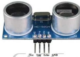
Figura 15.. Sensor HC-SR04. Imagen tomada de ELEC Freaks.
