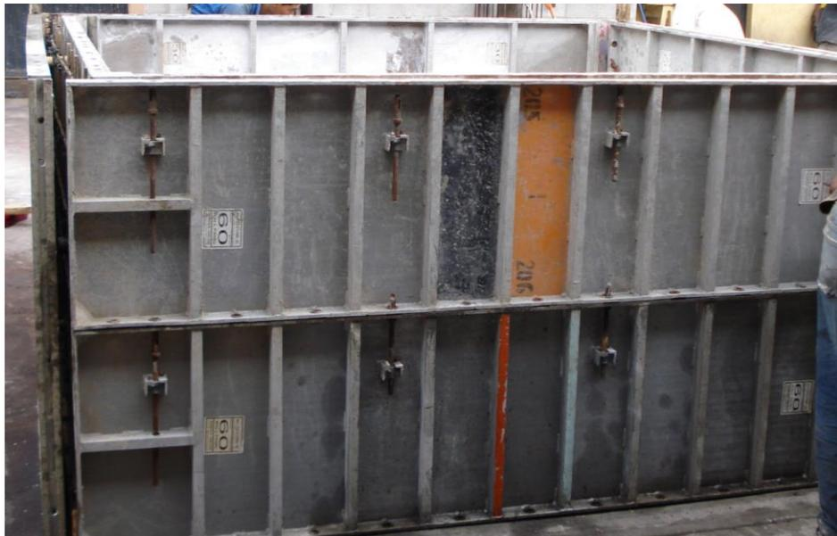
Figura #14, cimbra para pieza #2 anillo de caja de infiltración prefabricada
