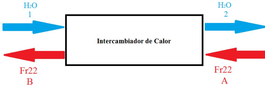
Esquema 1.- Intercambiador de calor con flujos de agua y refrigerante.
