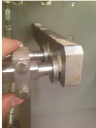
*Figura 2 Guías de apertura de bolsa fuera de posición.*
