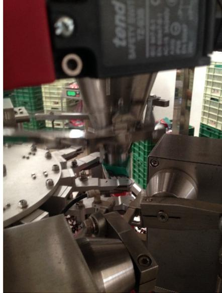
*Figura 10 Cono de descarga vibrando y llenando correctamente.*
