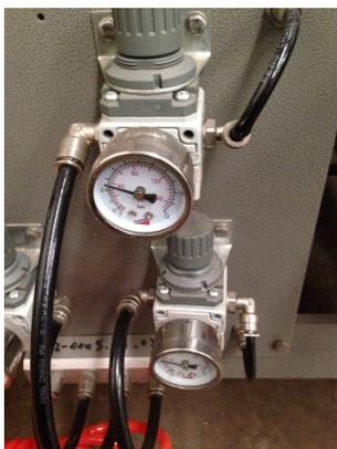
*Figura 3 Instalación de manómetros.*
