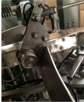
*Figura 7 Pinza de apertura de bolsa.*
