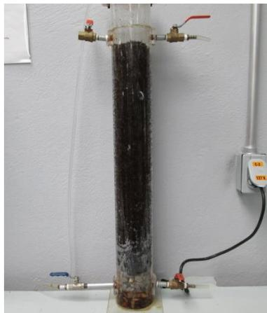
**Figura 4.1** Sistema de Biofiltro empacado con turba
