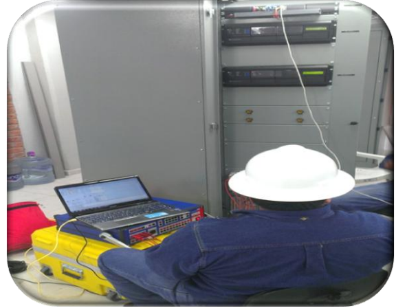
Fig. 11.- Pruebas a esquemas de protección
