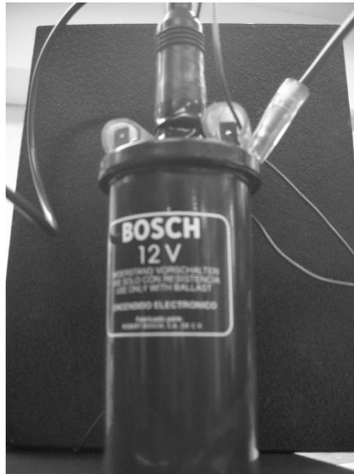
Fig. 46. Bobina de Ignición automotriz.
