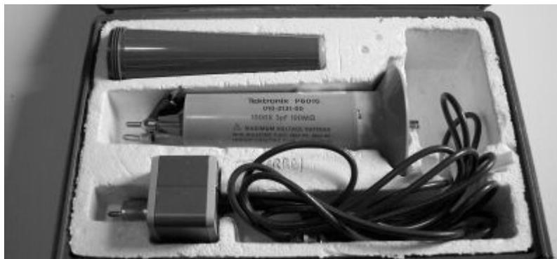
Fig. 51. Punta de alto voltaje.
