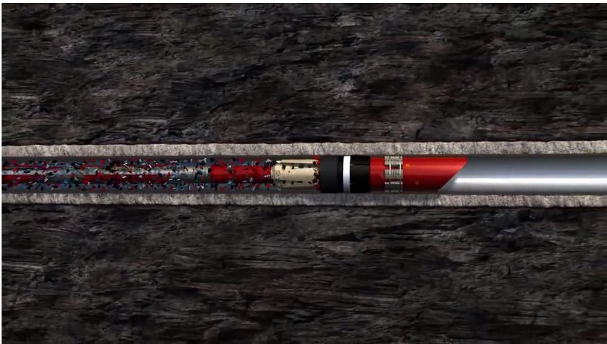
Figura 5.8 Molienda de los Tapones (Weatherford, 2014)
