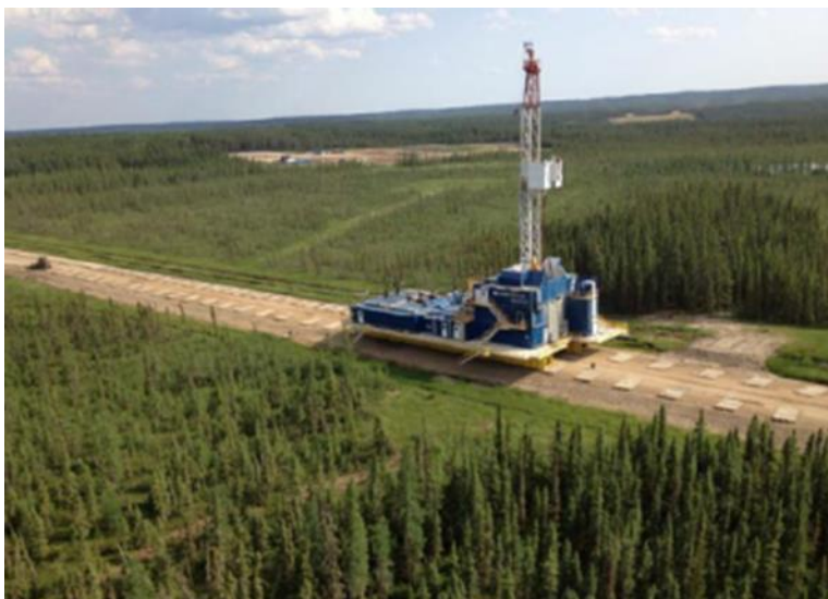
Figura 4.4 Equipo de Perforación Móvil (Modificado de Domínguez, 2013)
