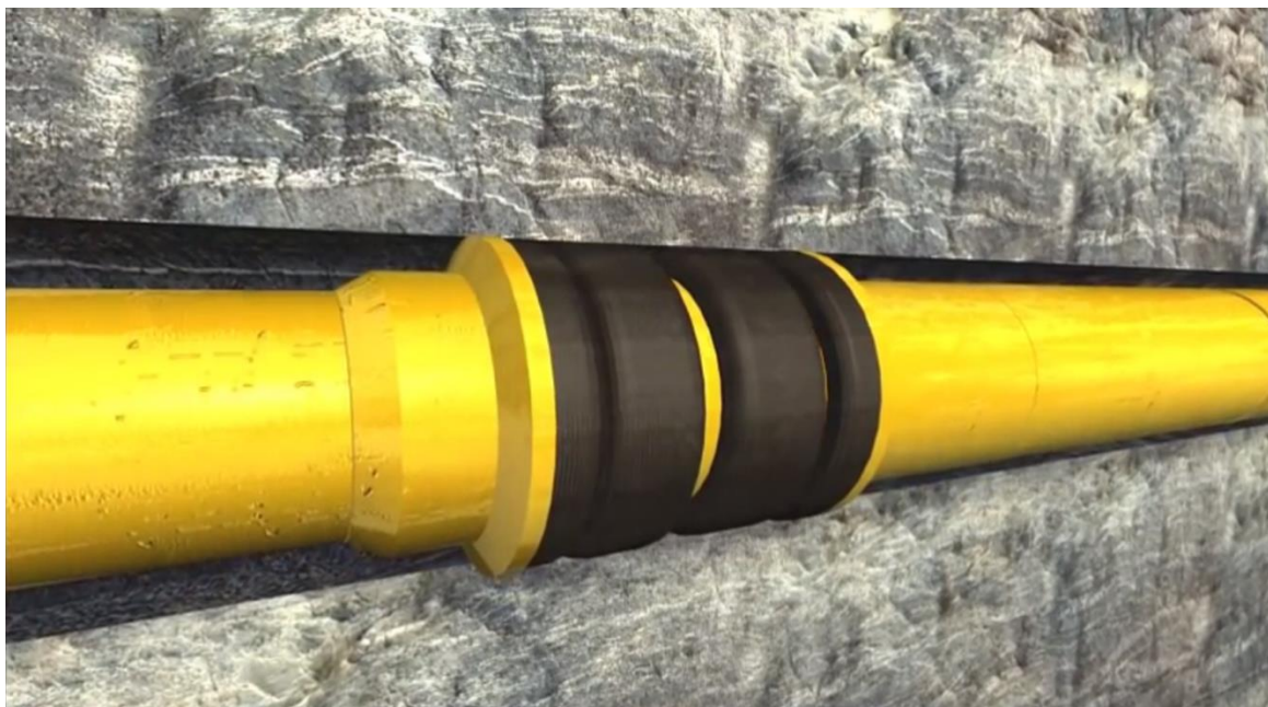
Figura 5.10 Instalación de los Empacadores (Baker Hughes, 2010)
