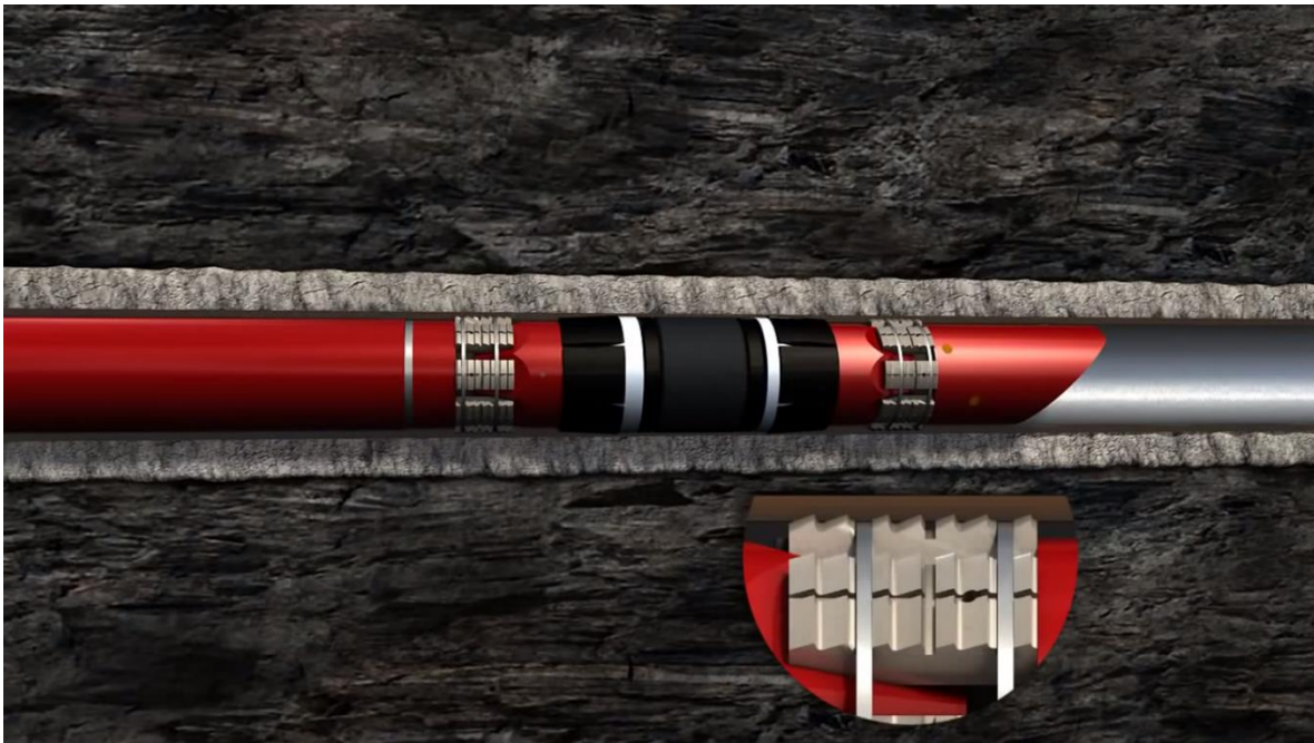
Figura 5.4 Colocación del Siguiete Tapón (Weatherford, 2014)
