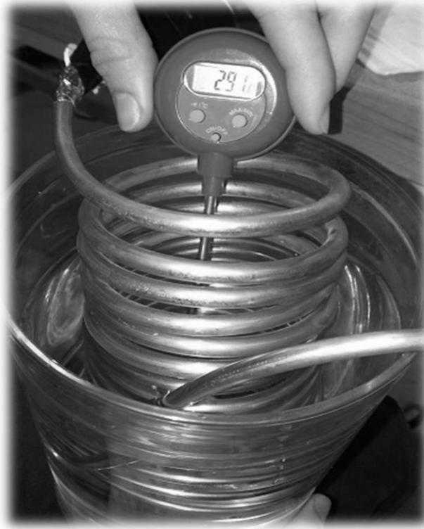
Figura 31. Conducción con Serpentes
