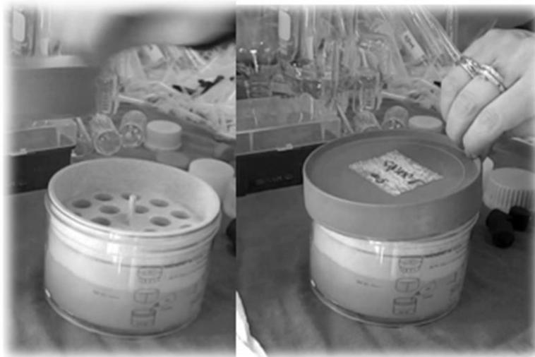
Figura 37. Inmersión en Alcohol Isopropílico
