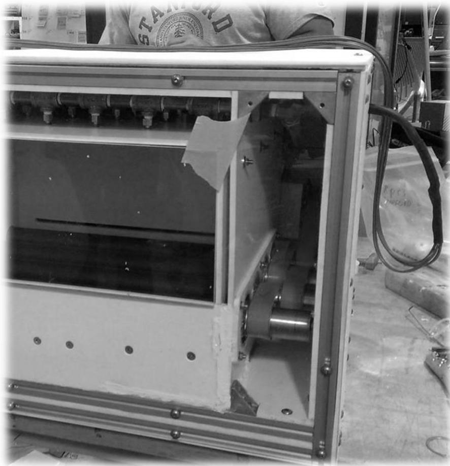
Figura 72. Sistema de Transmisión de Potencia por Bandas Planas
