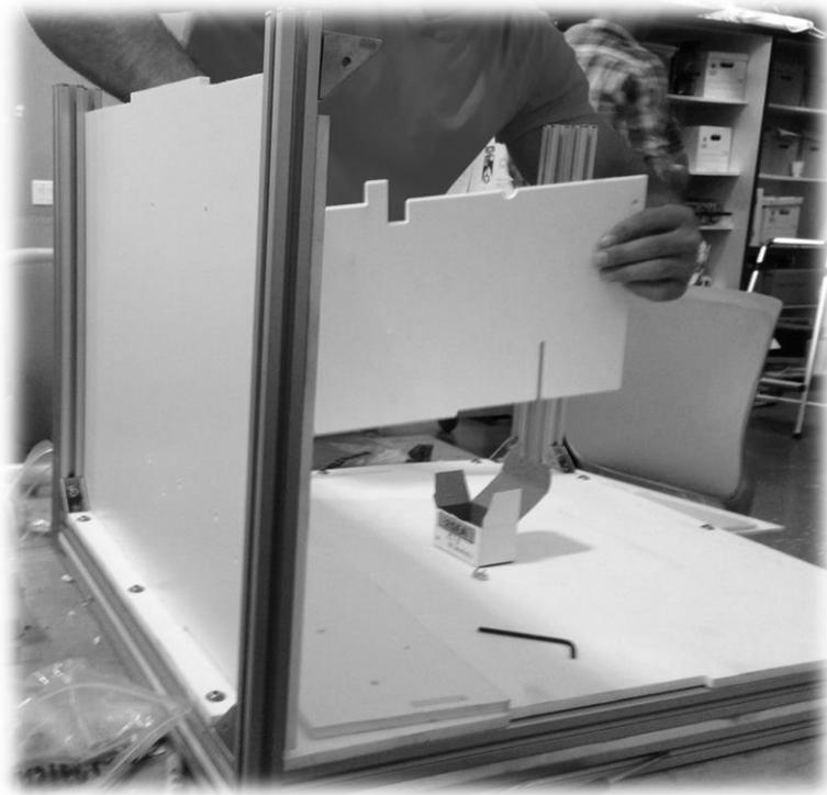
Figura 67. Colocación de Paredes de PE-HD
